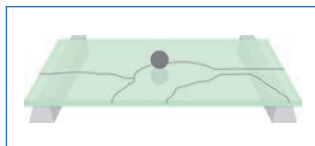
Vidrio laminado de seguridad formado por 2 vidrios termoendurecidos - panel superior roto
