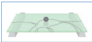
Vidrio laminado de seguridad formado por 2 vidrios termoendurecidos - ambos paneles rotos
