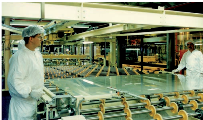
Producción de vidrio laminado de seguridad: sala blanca
