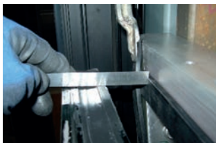
Auslenkung (dZ): Isolierglaseinheit vor dem Aufbringen der Verformungskräfte
