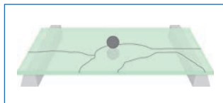
Laminowane szkło bezpieczne składające się z 2 półhartowanych szyb - górna tafła uszkodzona
